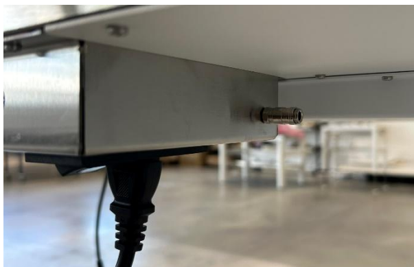
Figura 11.1 Entrada de gás por baixo do tampo da mesa Single
