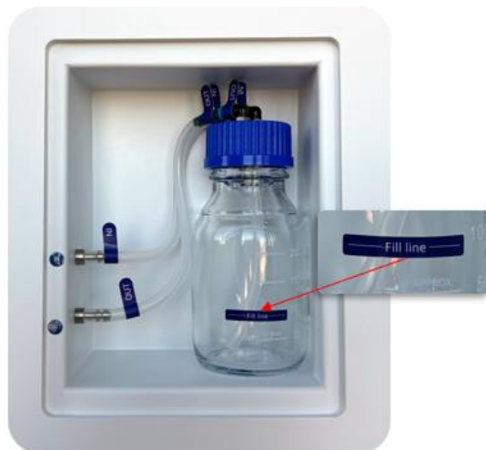
Figura 21.1 Ligação do tubo à garrafa de humidificação e à Estação de Trabalho Multizona TRA
